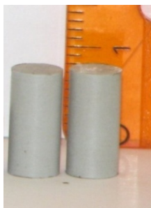
Figura 17: corpos de prova de compressão.
