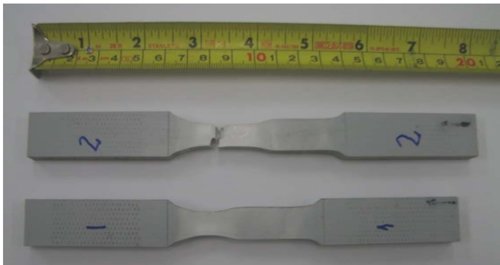
Figura 20: corpos de prova de PVC após ensaios de tração.
