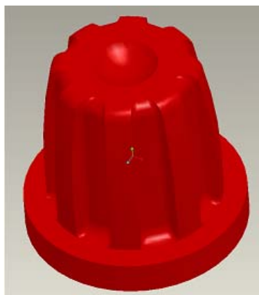
Figura 1: batente plástico utilizado como absorvedor de impacto em sistema de suspensão de compressores de refrigeradores domésticos.
